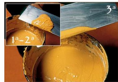
Schritt 6 - Hier sehen Sie die 2 unterschiedlichen Festigkeiten. Verwenden Sie besonders für die dritte Schicht unsere speziellen Spatel.
