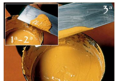
Étape 6 - Voici l'image des 2 différentes consistances. Surtout pour la troisième couche, nous conseillons d'utiliser nos lames à enduire spéciales.
